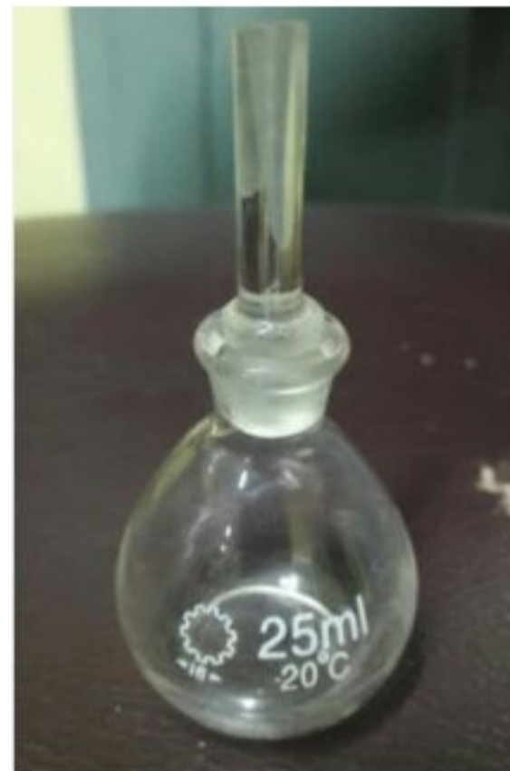
Gambar 7. Piknometer Volume 25 ml
